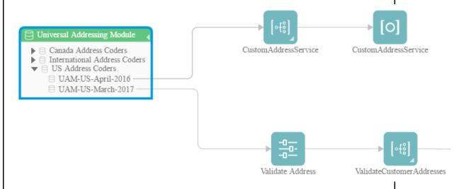
この図から、Validate Address のデフォルト サービス オプションは新しいデータベース (UAM-US-March-2017) を使用していますが、CustomAddressService フローはまだ古いデータベース (UAM-US-April-2016) を使用していることがわかります。 Enterprise Designer で CustomAddressService フローを開き、新しいデータベースを使用するように Validate Address ステージを変更します。図を更新すると、今度は次のように表示されます。
