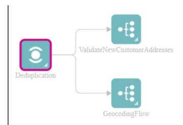
系統および影響分析の図に、Deduplication サブフローが ValidateNewCustomerAddresses と GeocodingFlow という 2 つのフローで使用されていることが示されます。変更を加えるときに、Enterprise Designer でこれらのフローをチェックすることで、希望どおりの結果が得られることを確認できます。
