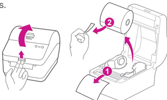
Installez le rouleau d'étiquettes et faites passer celles-ci dans le guide du support. Fermez le couvercle.
