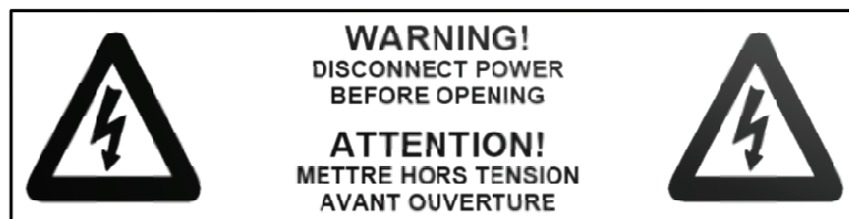
FIGURE 1 : Étiquette d'avertissement contre un danger électrique
